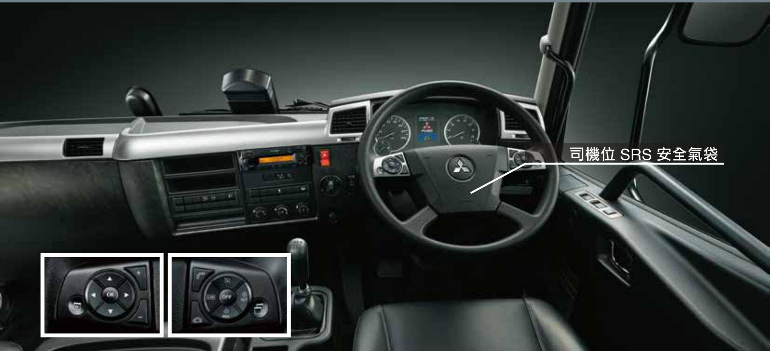
多功能軚環控制系統方便行車時操控及查閱資訊
