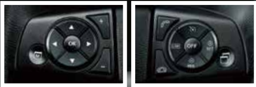
多功能軚環控制系統方便行車時操控及查閱資訊
